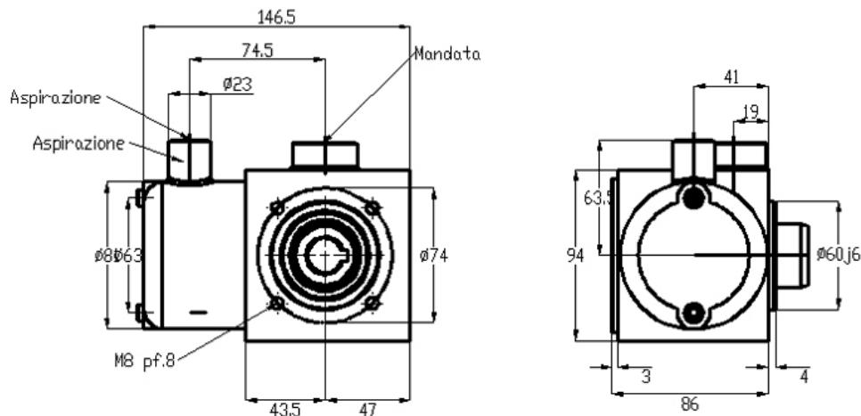
**Pompa ermetica ad uso esterno con aspirazione assiale: PR1-....-A**
